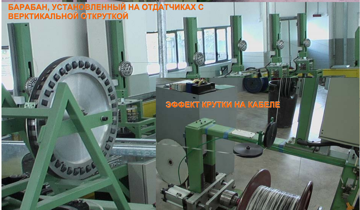
БАРАБАНЫ С НЕСКОЛЬКИМИ СТЕПЕНЯМИ СВОБОДЫ, УСТАНОВЛЕННЫЕ НА ЛИНИИ СКРУТКИ С ПЕРЕМЕННЫМ S-Z
