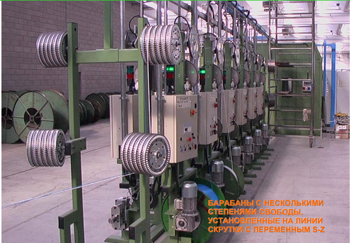
БАРАБАН, УСТАНОВЛЕННЫЙ НА ОТДАТЧИКАХ С ВЕРТИКАЛЬНОЙ ОТКРУТКОЙ
